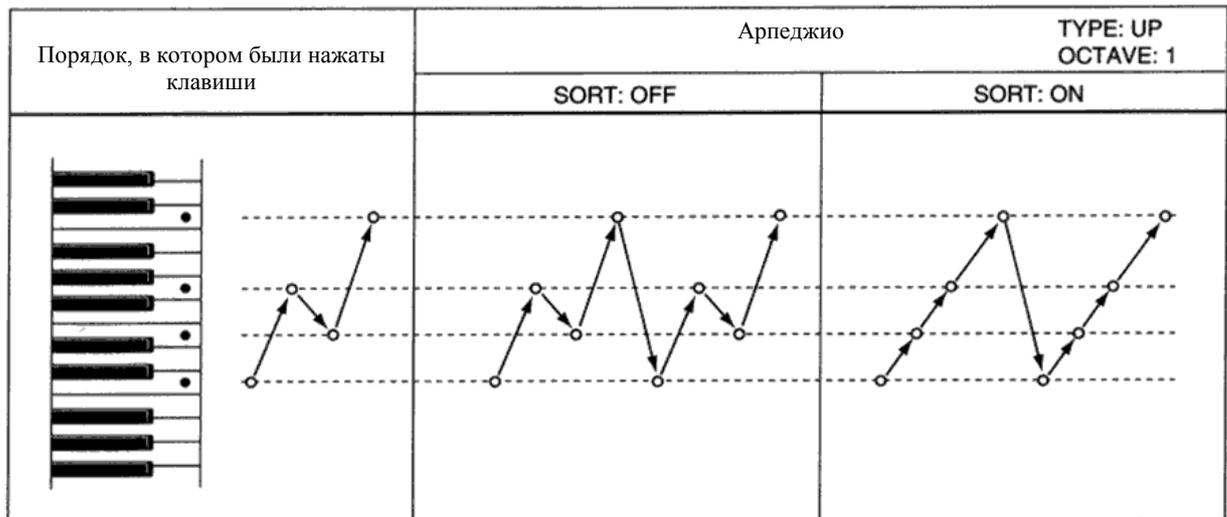
Например, если параметр Type находится в положении UP, а Sort в положении ON, то нажимаемые вами на клавиатуре клавиши будут проигрываться в порядке арпеджио от низкого к высокому звуку. Тем не менее, если Sort находится в положении OFF, ноты арпеджио будут проигрываться в том порядке, в каком они были извлечены. Если Type находится в положении RANDOM, данный параметр не работает.
